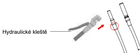
Obr. 5.4 Zakrimpujte pin kontaktu ke kabelu
